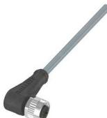
带电缆线的接插件 BCC M425-0000-1A-001-VX8334-050, 279326 (MTS).<br>接口 = M12x1母头, 弯头, 5针, A编码   电缆 = PVC 灰色, 5 m, 牵引链适用   导线数量 = 3   导线截面 = 0.34 mm <sup>2</sup>   电缆温度, 固定敷设 = -40...105 °C   电缆温度, 柔性敷设 = -5...105 °C   工作电压Ub = 250 VDC / 250 VAC   额定电流 (40 °C) = 4.0 A   防护等级 = IP67, IP68, IP69K   许可/一致性 = CE, cULus, WEEE |         |    |    |     |       |        |     |        |
