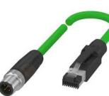
带电缆线的接插件 BCC M414-E834-8G-668-PS54N2-100, 255832 (MTO).<br>接口1 = M12x1-插头, 直头, 4-针, D-编码   接口2 = RJ45-插头, 直头, 4-针   接口 = Profinet   电缆 = PUR 屏蔽 绿色, 10 m, 牵引链适用   导线数量 = 4   电缆温度, 固定敷设 = -40...80 °C   电缆温度, 柔性敷设 = -20...60 °C   工作电压Ub = 30 VDC   额定电流 (40 °C) = 1.5 A   防护等级 = IP67/IP20   许可/一致性 = CE, cULus, WEEE |         |   |    |     |        |        |     |          |
