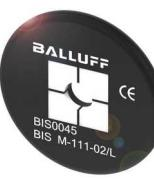
编码块 BIS M-111-02/L, 264391 (MTS).<br>产品组别 = HF (13.56 MHz)   尺寸 = Ø 30 x 2.8 mm   UID序列号, 只读 = 8 Byte   用户数据, 读/书 = 2000 Byte   存储器类型 = FRAM   支持的数据载体类型 = DIN ISO 15693   天线形状 = 圆形   安装 = 无金属 (缓冲区)   存储温度 = -25...85 °C   临时仓储温度 = 140 °C 1x100 h; -40 °C...90 °C 1x1000 h   环境温度 = -25...85 °C   外壳材料 = PA 6   防护等级 = IP68   许可/一致性 = CE, UKCA, WEEE |         |    |    |     |       |        |     |          |
